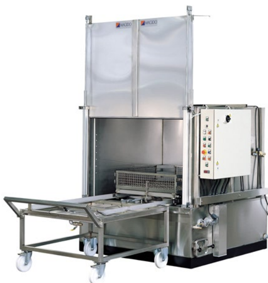
Umývacím strojom s tryskami s 10% vody
